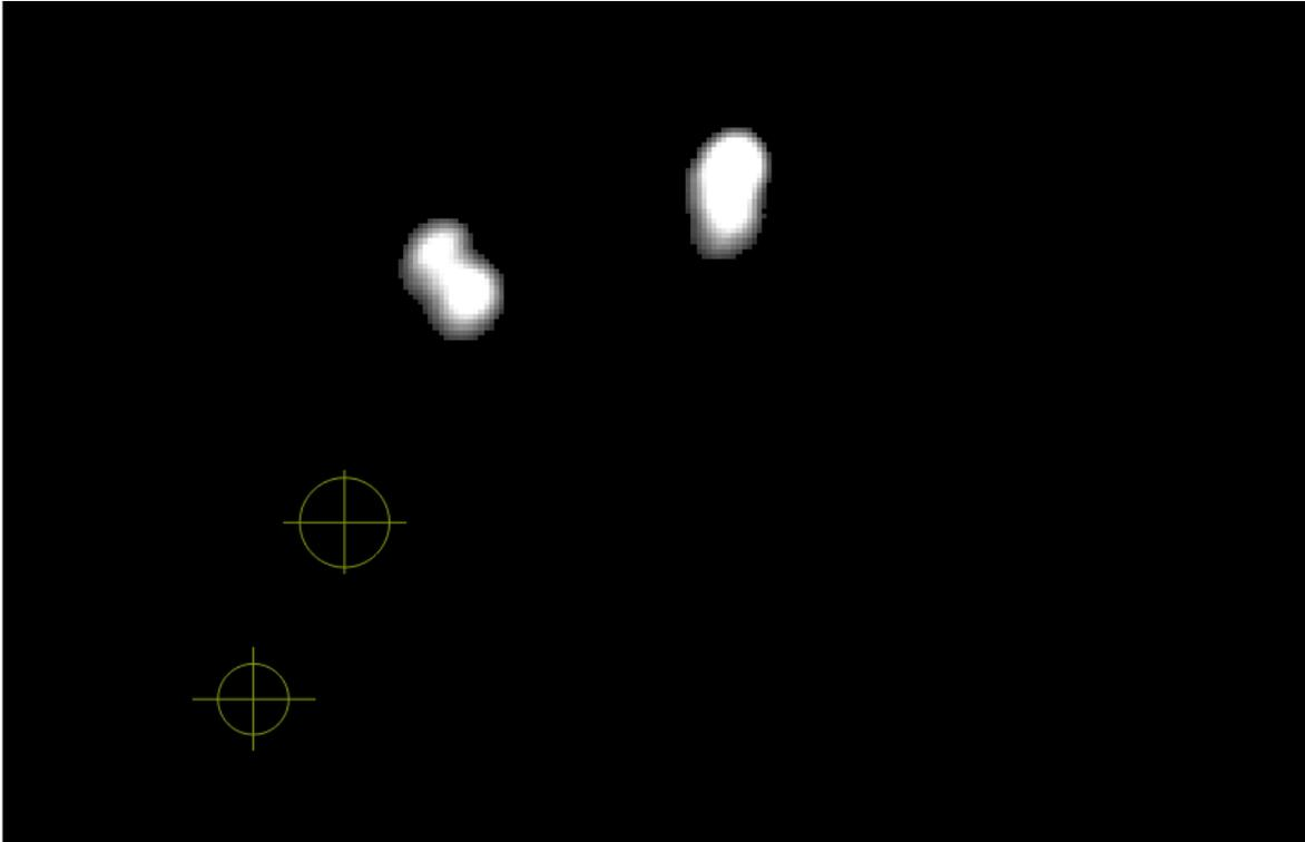
Un correcto ajuste óptico de las cámaras es aquel que no tiene rebotes de brillos de luz y detecta todos los puntos con el círculo y la cruz:
